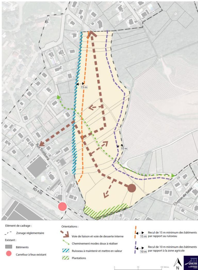
Afin de conserver un aménagement à échelle humaine et préserver les vues, le règlement définit les hauteurs maximales de construction (10 m), la morphologie des clôtures ainsi que la distance entre les constructions ( $H/2 > 3$  m).
