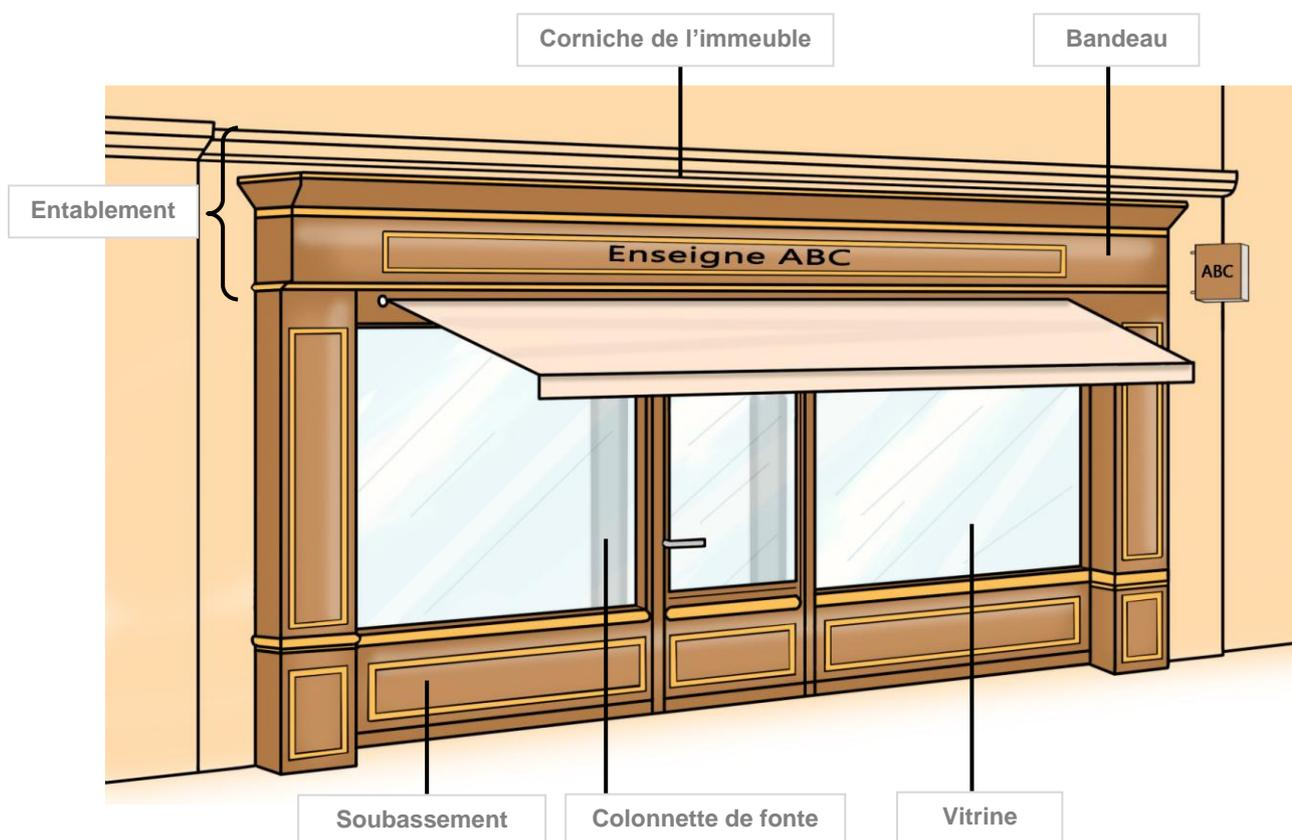
Fig.8 : Eléments composants la devanture commerciale
