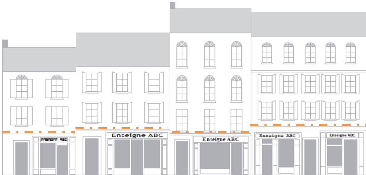
Fig.6 : Les lignes horizontales des rez-de-chaussée marquent la limite du socle de la façade urbaine.
