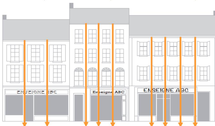
Fig.5 : Les pleins et les vides (baies) des étages ne se poursuivent pas en rez-de-chaussée.
