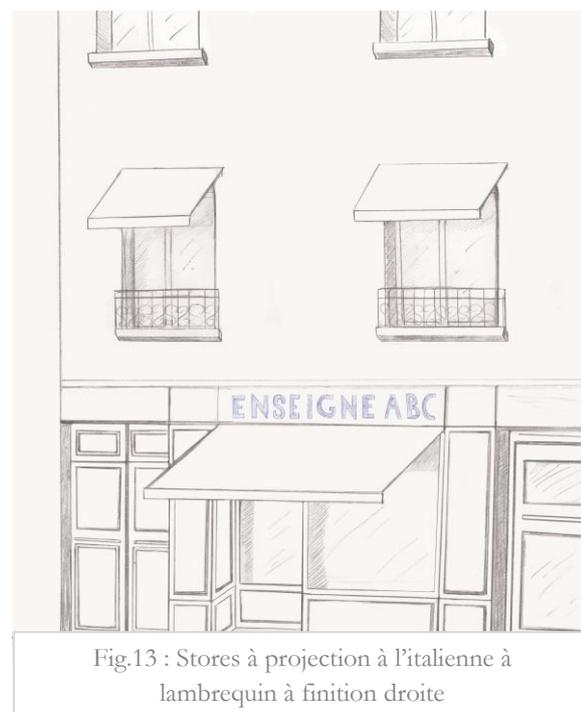
Fig.13 : Stores à projection à l'italienne à lambrequin à finition droite
