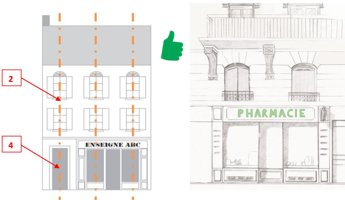
Fig.3 : Les axes de composition de la devanture poursuivent ceux de la façade de l'immeuble. L'accès aux étages doit être maintenu.
